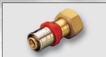
Art. TM 1666 přímý přechod s převlečnou matkou pro připojení vícevrstvých trubek (EUROCONUS)
