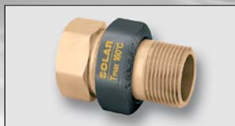
Art. CLF.588xxx 3 dílné šroubení pro solární systémy T_{max} = 160^{\circ}C , P_{max} = 16 bar maximální obsah glycolu v médiu 50%
