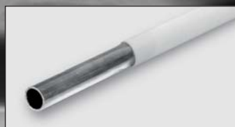
Art. FPC.TRxxPP pozinkovaná trubka z uhlíkové oceli EN 10305-3 v plastovém (PP) obalu (délka 6 m)
