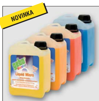
Art. GB.LI750xx utěšňovací chemický přípravek GEBO®Liquid pro topné soustavy na silikátové bázi s podílem vláknů. Kanystr 2 litry. Mísící poměr 1:100. Utěšňovací místa trvale a zevnitř bez demontáže systému. Pro železo, ocel, litinu, měď, hliník, plast. P max = 10 bar, T max = 1200°C
